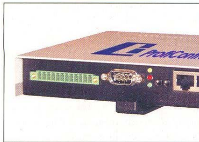
Bild 1: ProfiControl-Zentraleinheit für Wand- oder Hutschienenmontage
