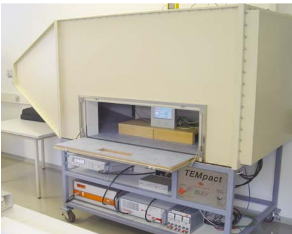
HF-Einstrahlung in der TEMpact Meßzelle
